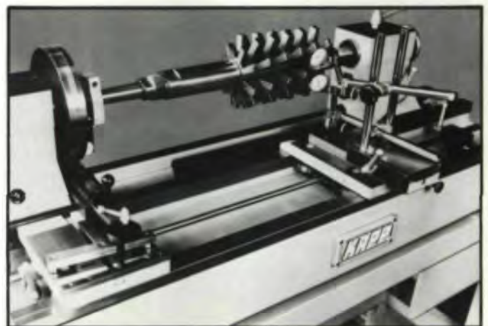
Fig. 24—Hob checking unit.
